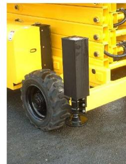
**ПРИМЕЧАНИЕ:** *Опускание выносных опор производится при автоматическом увеличении оборотов ДВС, подъем – без увеличения оборотов ДВС.*
