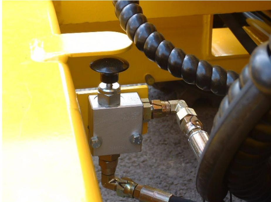
**ПРИМЕЧАНИЕ:** При аварийном опускании рабочей платформы с выдвинутыми выдвижными секциями, а также при использовании пульта управления на базовом шасси, необходимо убедиться в отсутствии препятствий и посторонних предметов под платформой и выдвижными секциями.
