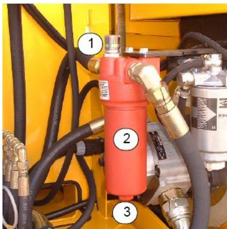
Рисунок 26. Фильтрующий элемент гидравлической жидкости
