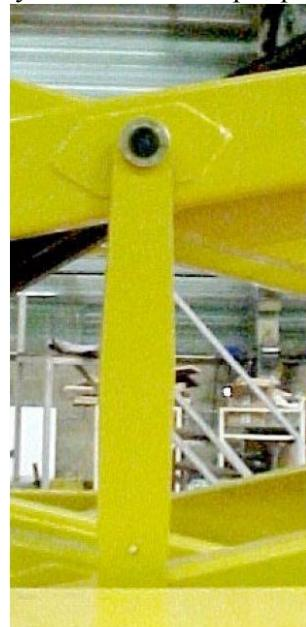
Фиксатор стрелы (рисунок 23, 24) предназначен для обеспечения безопасности при ремонте и обслуживании подъемника.
