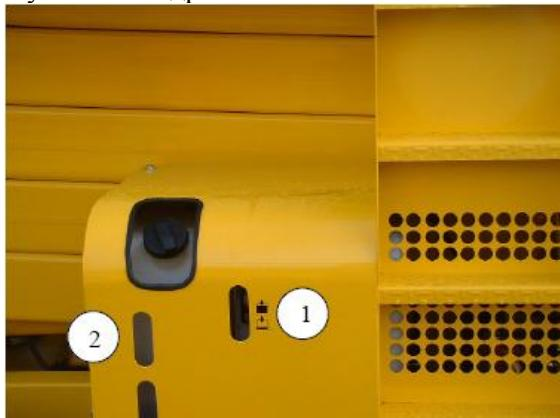
Рисунок 16. Уровень моторного масла в ДВС.
