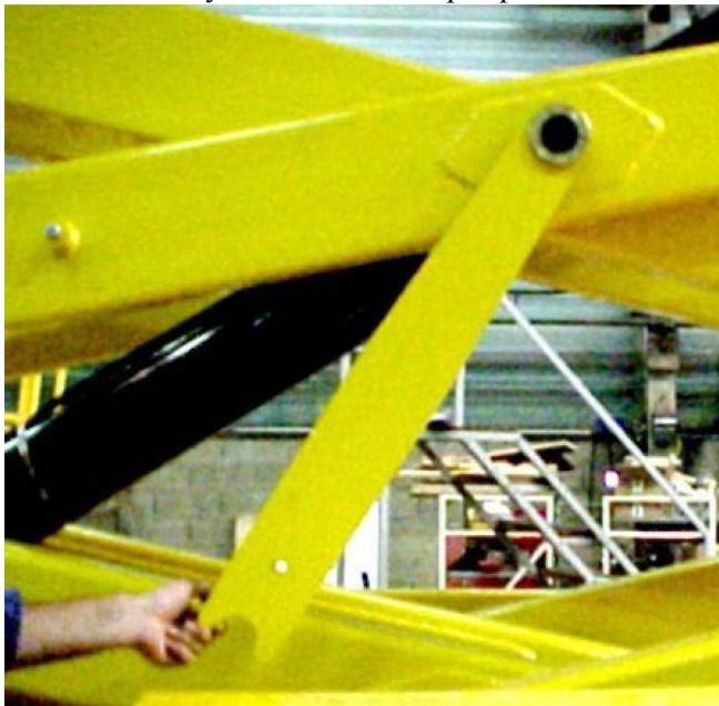
Рисунок 24. Фиксатор стрелы.
