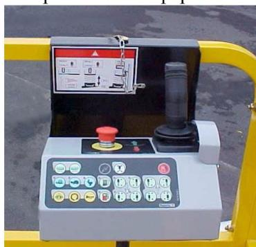
Рисунок 11. Органы управления на пульте управления на рабочей платформе
