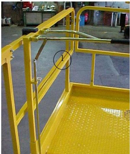
Рабочая платформа подъемника оснащена двумя выдвижными секциями.
