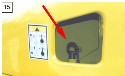
Рисунок 15. Шкворень блокировки поворота опорно-поворотного устройства.
