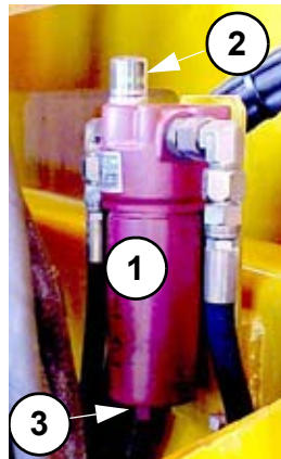
Фотография 16 - Гидравлический масляный фильтр контура перемещения
