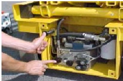
Рисунок 24. Аварийное растормаживание колес подъемника.
