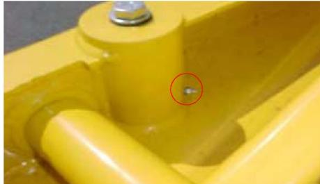
Рисунок 28. Пресс-масленка смазки шкворней управляемых колес.
