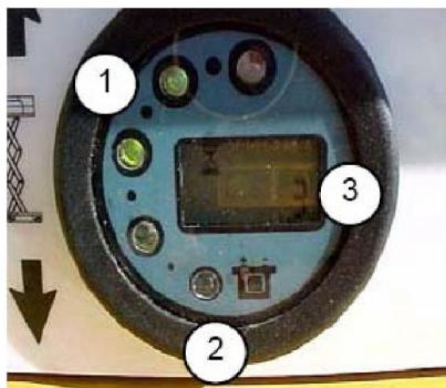
Рисунок 9. Счетчик моточасов.
