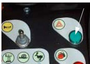
Рисунок 10. Индикатор неисправности.
