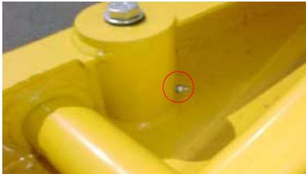
Рисунок 28. Пресс-масленка смазки шкворней управляемых колес.
