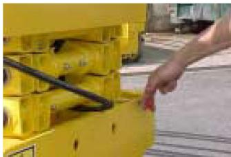
Рисунок 23. Тяга аварийного опускания рабочей платформы.
