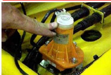
Рисунок 11. Указатель наклона
