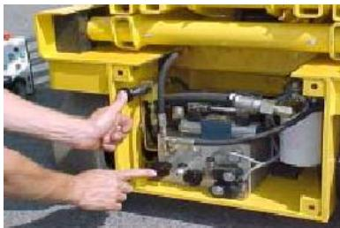
Рисунок 24. Аварийное растормаживание колес подъемника.
