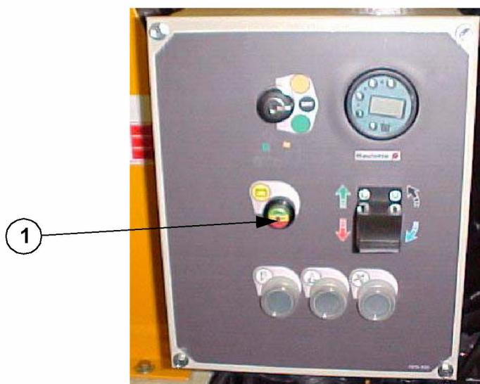
В процессе заряда, при помощи светового индикатора, можно получить информацию о процессе заряда аккумуляторных батарей.
