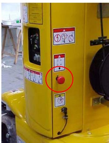
Рисунок 16. Кнопка аварийной остановки.
