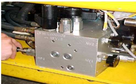
Рисунок 24. Аварийное растормаживание колес подъемника.
