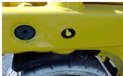
Рисунок 29. Шкворни управляемых колес.
