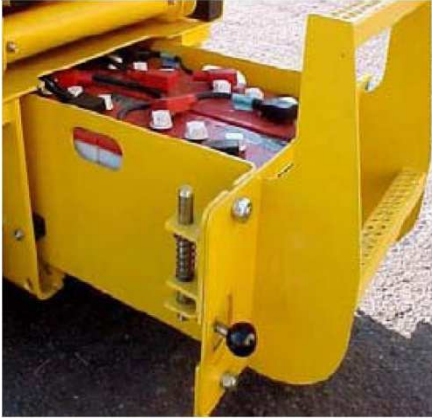
Рисунок 21. Секция аккумуляторных батарей.
