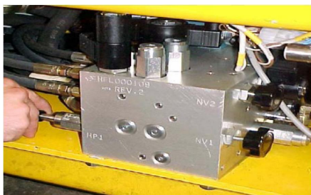
Рисунок 24. Аварийное растормаживание колес подъемника.
