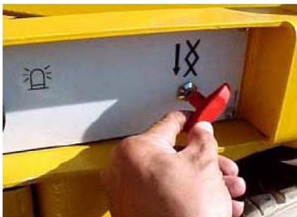
Рисунок 23. Тяга аварийного опускания рабочей платформы.
